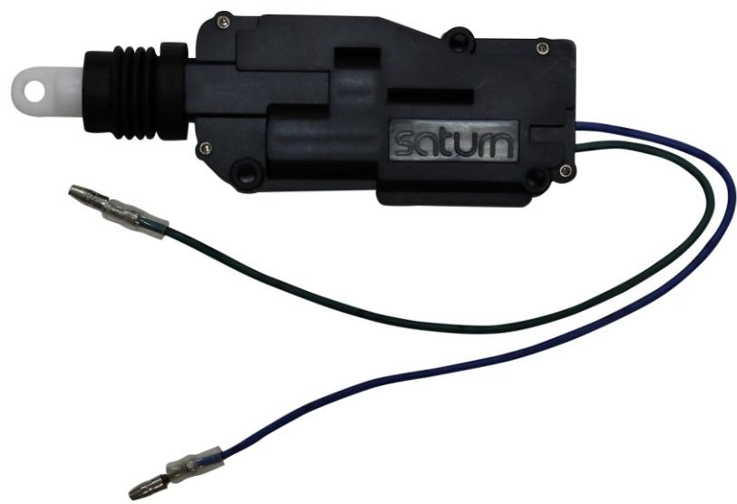
Рисунок 5.1 - активатор (привод центрального замка авто Saturn ms-200)
